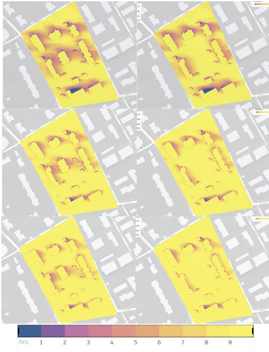
Auringonvalotarkastelu: Huhtikuun, Toukokuun ja Kesäkuun 15. päivä. Vasemmalla on valotarkastelu viitesuunnitelman mukaisesti ja oikealla on nykytila. Tarkastelu ei ota huomioon olemassa olevan kasvillisuuden vaikutuksia. Värit esittävät auringonvalon tuntimäärää. (Järvenpään kaupunki 7/2025.)
